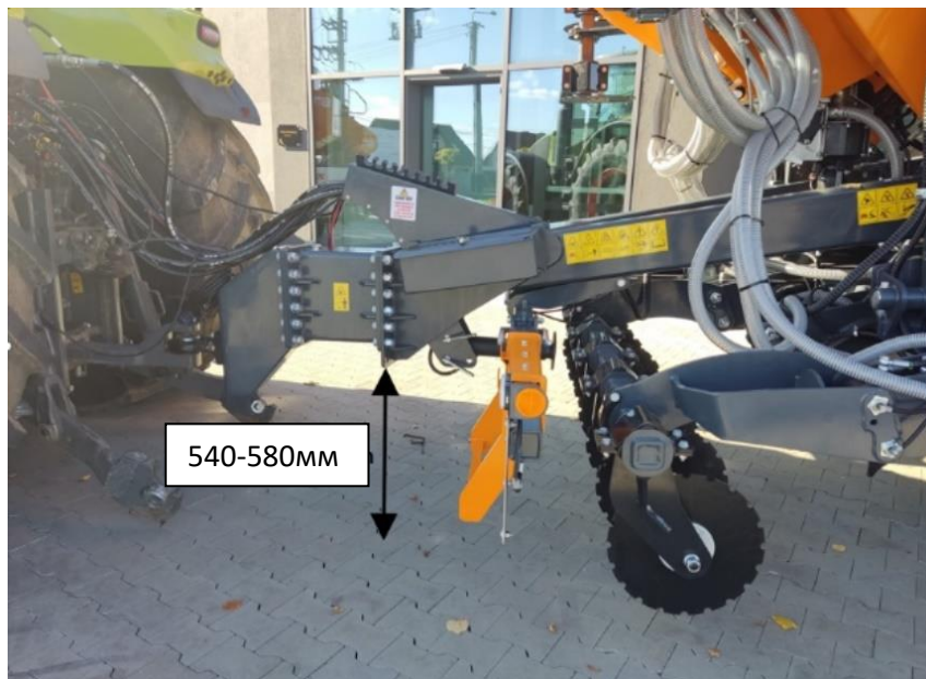
Мал. 30 Вимірювання висоти між дишлом і землею
