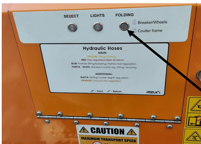
Мал. 35 Панель приладів з вибраною глибиною складання/розкладання глибокорозпушувачів/вісі колес
