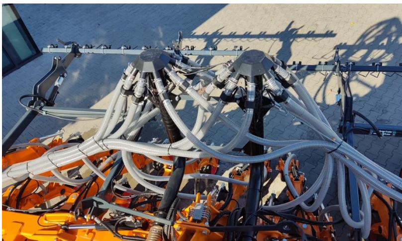
Мал. 64 Вид на висівні головки з датчиками потоку насіння
