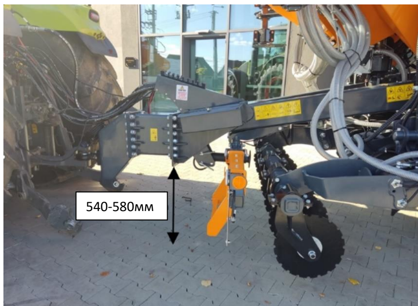
Мал. 29 Вимірювання висоти між дишлом і землею
