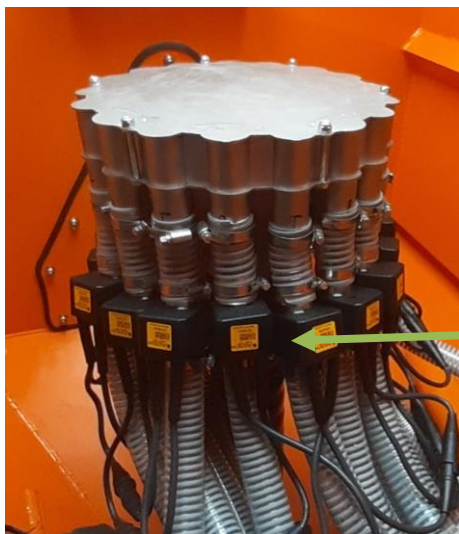
Мал. 90 Датчики потоку в головці для внесення добрив
