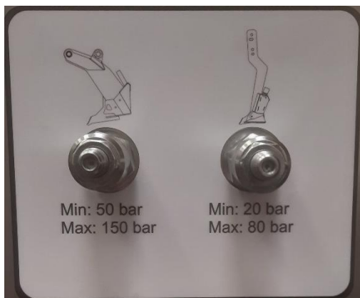
Мал. 52 Тиск у запобіжних серводвигунах
