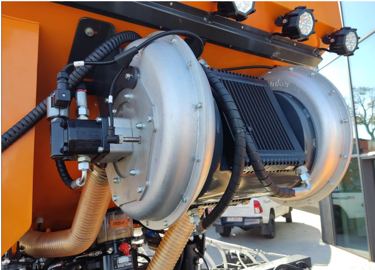
Мал. 15 Вентилятори - привід і охолоджувачі
