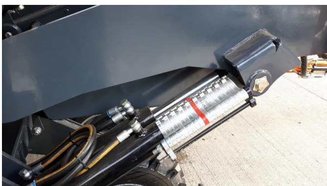
Мал. 44 Встановлені обмежувачі для підйомного серводвигуна висівної рами
