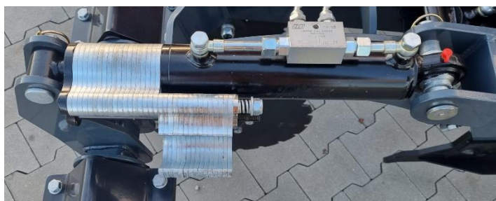
Мал. 10 Регулювання робочої глибини дисків
