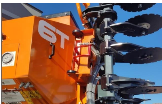
Мал. 40 Платформа баку - у складеному вигляді Мал. 39 Платформа баку в розкладеному вигляді
