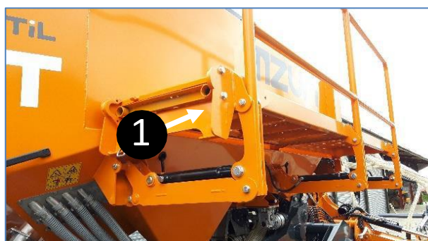
Мал. 40 Платформа баку - у складеному вигляді Мал. 39 Платформа баку в розкладеному вигляді
